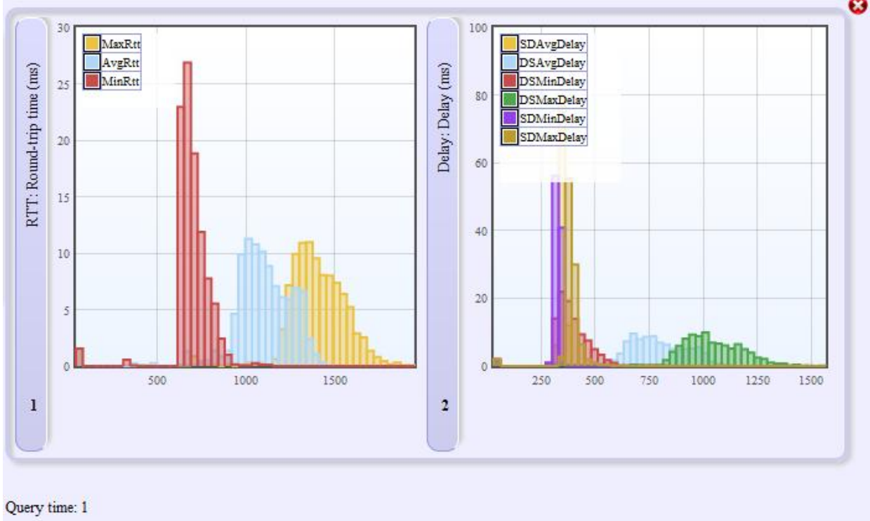
Рисунок 16 частотное распределение круговых и односторонних задержек
